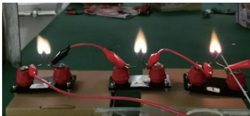
图2 三对电极串联情况下成功起弧
