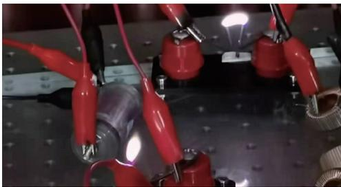
图 10 两对电极并联情况下成功起弧
