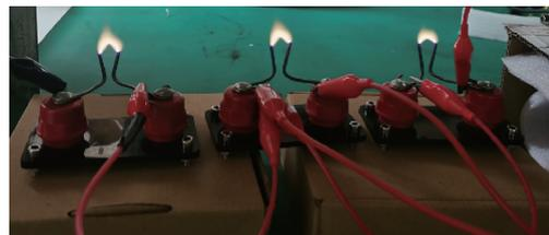
图 6 三对电极并联情况下成功起弧
